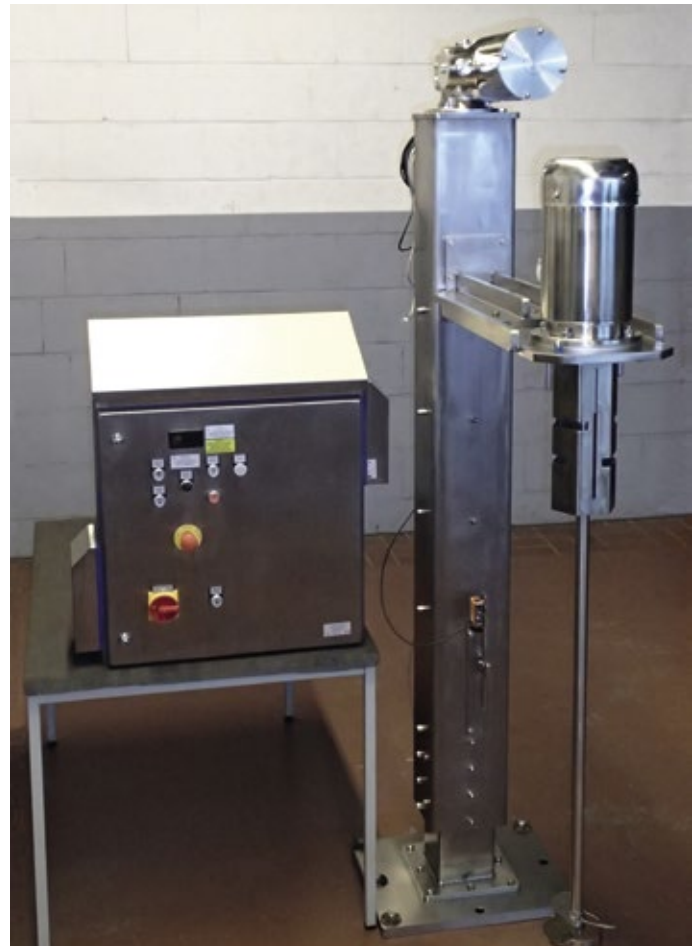
Abb. 2: IBS-Pharmastativ mit Schaltschrank komplett aus Edelstahl, Hub erfolgt elektrisch über eine Hubspindel, die in der Edelstahlvierkantsäule eingebaut ist, mit optischem Sensor zur Behältererkennung, verstellbarer Rührwerkstisch, dadurch Anpassung auf unterschiedliche Behälterdurchmesser möglich.
