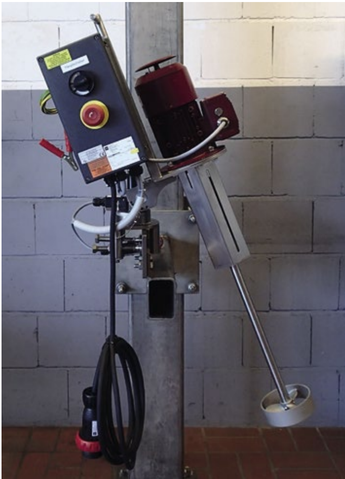
Abb. 1: Schwenkbares IBS-Anklemmrührwerk als flexible Komplett Einheit mit CE-Konformitätserklärung gemäß EG-Richtlinie 2006/42/EG und ATEX-Zulassung gemäß EU-Richtlinie 2014/34/EU.
