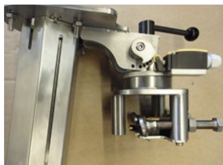
Abb. 3: Robuster IBS-Anklemmer aus Edelstahl mit Flansch für die Rührwerksaufnahme und Rollenschaltern für die Schwenkwinkelabfrage und Behältererkennung.
